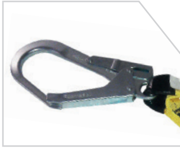
Gancho de acero de doble seguro tratado al calor, traccionado hasta 3,600 libras antes de salir de fábrica.
