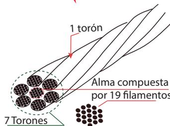
Cable de acero de 1/4", compuesto por 7 torones (6 torones de acero y un alma de acero).
