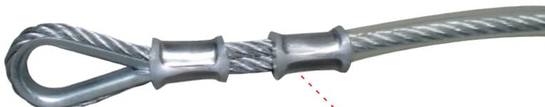
Prensado con férulas de aluminio , con una presión de 100 kg/cm<sup>2</sup>
